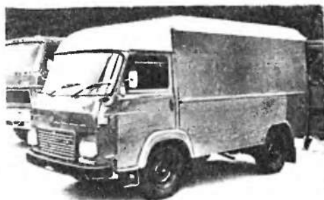
«АВИА-А21Ф» (1983). Два семейства дизельных грузовиков этой марки выпускает завод «Авиа» в Праге по лицензии фирмы «Рено». Фургон модели «А21Ф» экспонировался на выставке в Москве — многие тысячи «Авиа» разных модификаций работают в нашей стране. Рабочий объем двигателя — 3596 см 3 . Мощность — 83 л. с. (61 кВт). Длина машины — 5,0 м. Масса в снаряженном состоянии — 2,48 т. Грузоподъемность — 1,8 т. Скорость — 96 км/ч.
