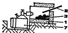
Простейшие горны. 1, 6 — кирпич, 2 — заготовка, 3 — уголь, 4 — колосниковая решетка, 5 — патрубок, 7 — паяльная лампа.
