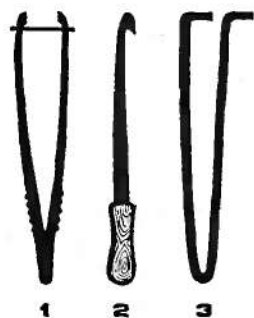
Приспособления для сбора плодов облепихи: 1 — растяжка (пинцет) с леской; 2 — скоба; 3 — пружинистый двухзахватный крючок.
